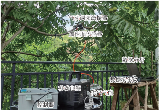
图 17 气动调频激振器试验
