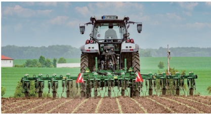
图 3 英国 RobocropInRow 智能锄草机 Fig.3 British RobocropInRow weeding machine
