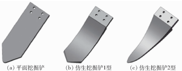
图 10 3 种挖掘单铲三维模型
