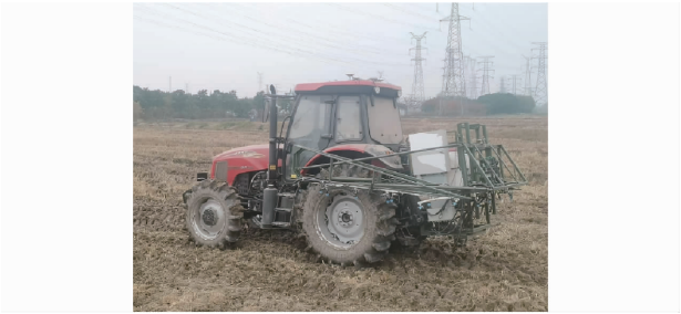
图9 装备无人农机自主导航系统的东风 1204 - CVT 型拖拉机
