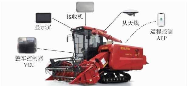
图 1 自动驾驶履带收获机系统组成 Fig.1 Hardware composition of auto drive crawler-type harvester
