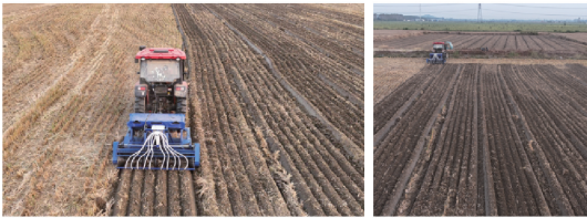
图 22 稻茬地微垄联合精量直播机田间试验
