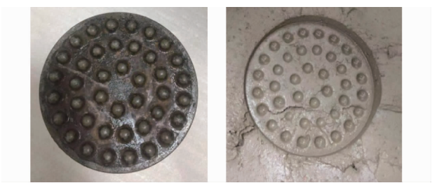
图 12 仿生压盘电渗试验后的压盘表面与土壤印痕(电压 24 V,通电时间 10 s)
