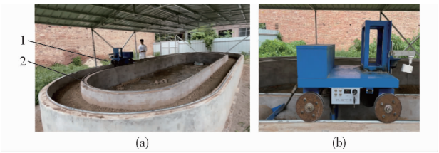
图 5 多功能农机触土部件磨损试验平台样机 Fig. 5 Prototype of functional agricultural machinery soil-engaging component wear test platform 1. 磨损试验装置 2. 闭环导轨
