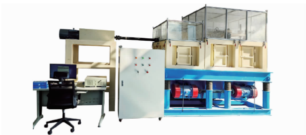
图 2 入土部件磨损性能试验台
