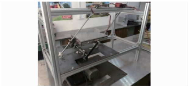
图8 振动加热脱附试验装置
