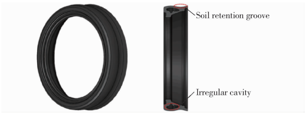
图 12 不规则腔体限深轮结构图
