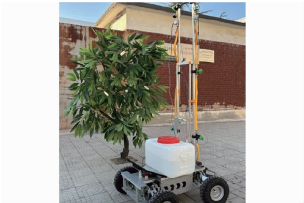
图 12 运动状态下的稳定性测试及雾滴沉积测试 Fig. 12 Stability test under motion and droplet deposition test
