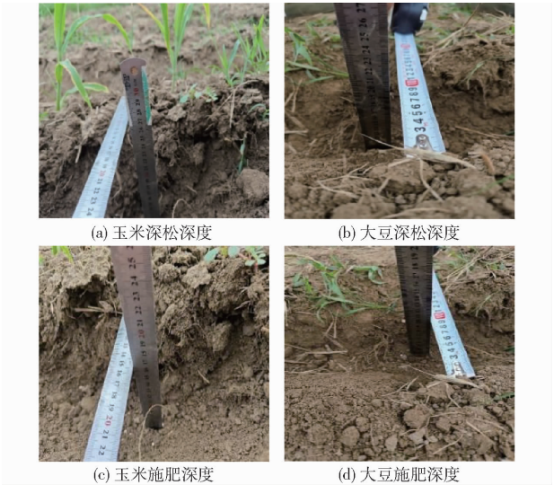
图 14 深松施肥作业深度测试
