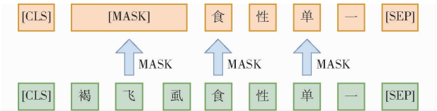
图 3 全词掩码示例 Fig. 3 Example of WWM
