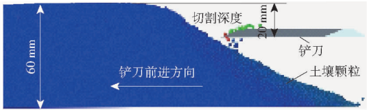
图 7 铲刀入土切割仿真试验
