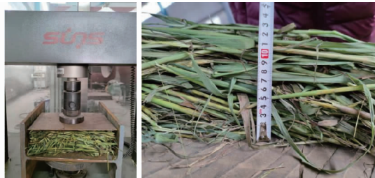
图 7 青燕麦草压缩特性试验
