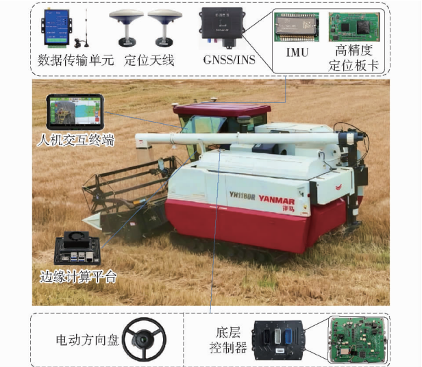
图 1 YH1180R 型履带式联合收获机自动驾驶试验平台 Fig.1 Autonomous navigation experimental platform of YH1180R tracked combine harvester
