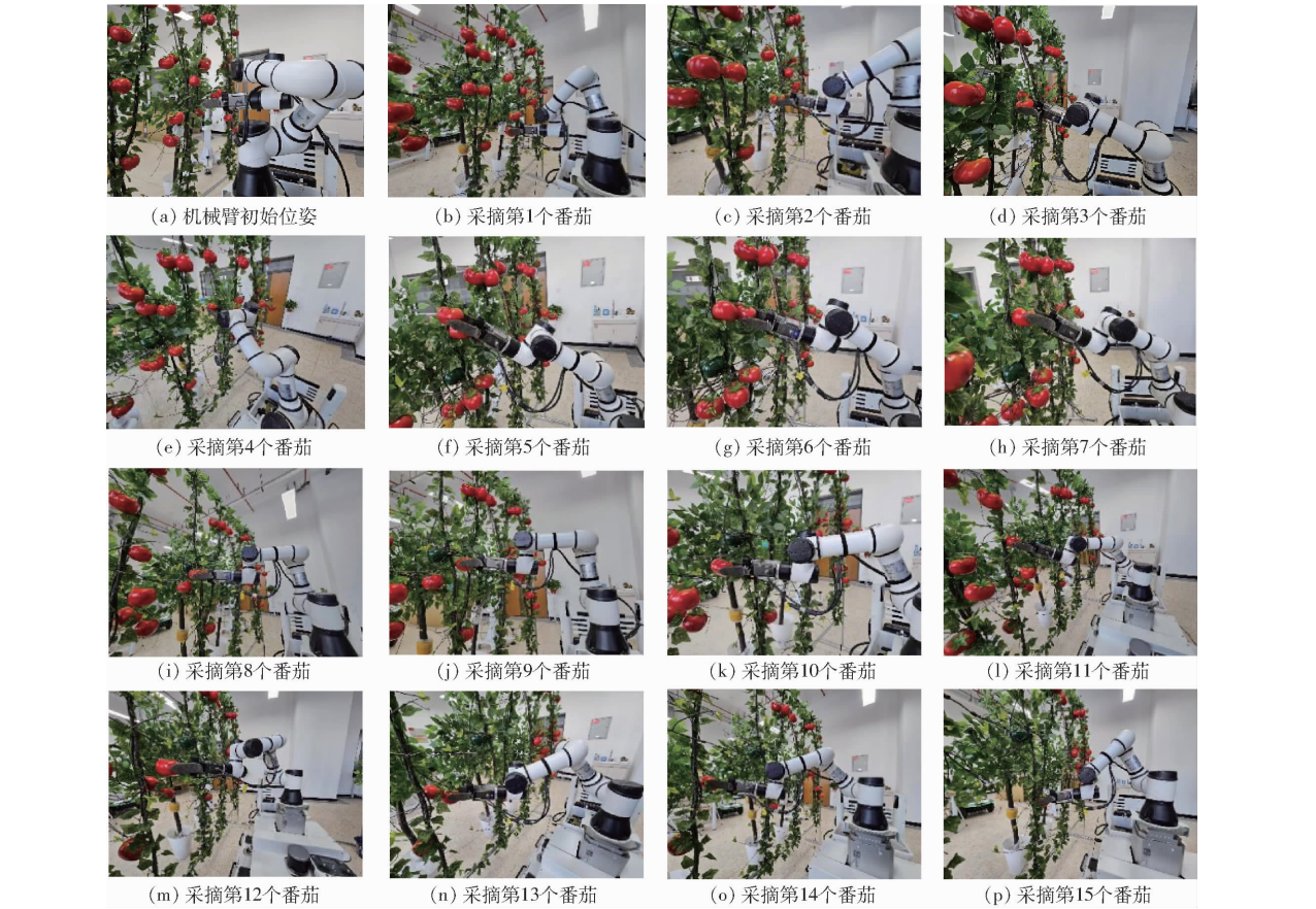
图 11 机械臂连续采摘实验
