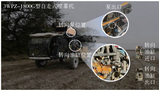
图 11 传感器安装位置 Fig. 11 Installation position of sensor
