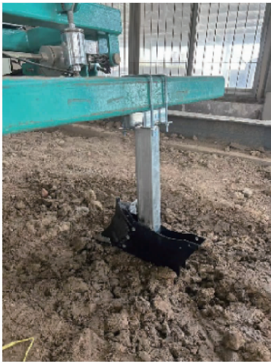
图 14 开沟器的安装固定
