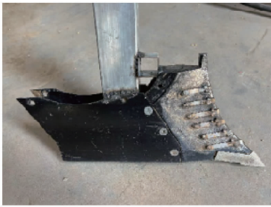
图 12 增加凸筋改形开沟器实物图
