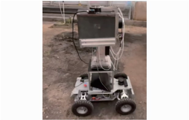
图 16 移动式表型采集装置验证试验
