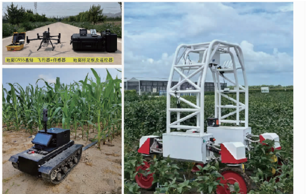
图 9 用于田间作物高通量表型的移动式表型平台
