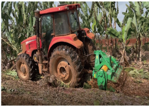
图 30 田间秸秆粉碎试验
