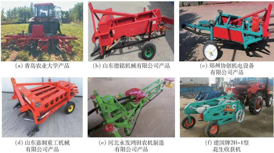
图 5 花生条铺收获机 Fig. 5 Peanut strip laying harvester
