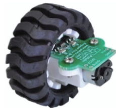
图 8 使用光学编码器的车轮里程计
