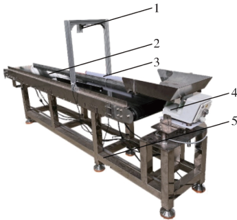
图 1 设备实物图 Fig.1 Physical drawing of equipment 1. 工业相机 2. 传输机构 3. 光源 4. 振动上料机构 5. 底座
