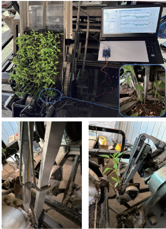
图 16 夹持力检测室内试验现场 Fig. 16 Clamping force testing indoor test site
