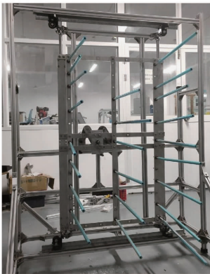
图 15 树冠振动机构样机 Fig. 15 Canopy shaking mechanism prototype
