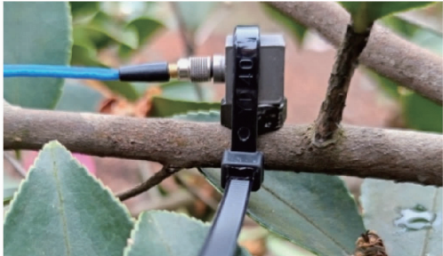
图 16 树枝上加速度传感器的布置 Fig. 16 Arrangement of accelerometers on branches
