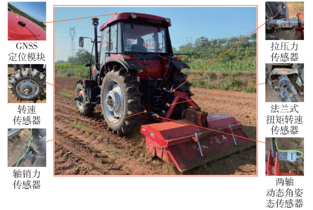
图 1 拖拉机多传感器综合测试系统传感器布置图
