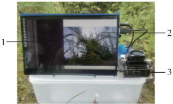
图 7 Jetson Nano 测试图 Fig. 7 Jetson Nano test diagram 1. 运行界面 2. 图像检测界面 3. Jenson Nano
