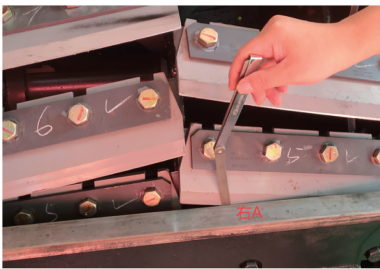
图 15 右 A 点间隙测量过程
