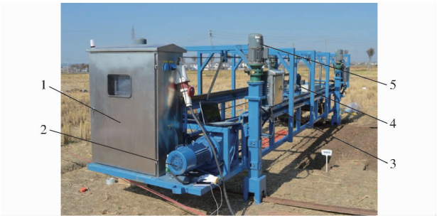
图 1 田间原位耕作综合试验平台 Fig. 1 Multi-purpose in-situ tillage tool testing platform 1. 控制系统 2. 牵引电动机 3. 悬架导轨 4. 多功能台车 5. 升降电动机
