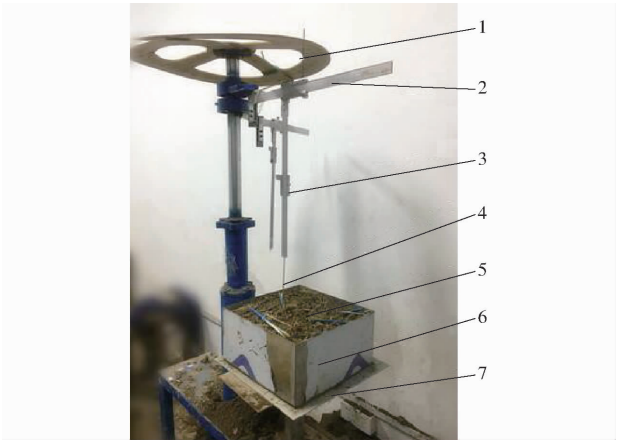
图 3 秸秆空间坐标数字化仪 Fig. 3 Space coordinate tester of straws 1. 弧形标尺 2. 水平标尺 3. 垂直标尺 4. 探针 5. 土样 6. 方形钢制取样桶 7. 底座
