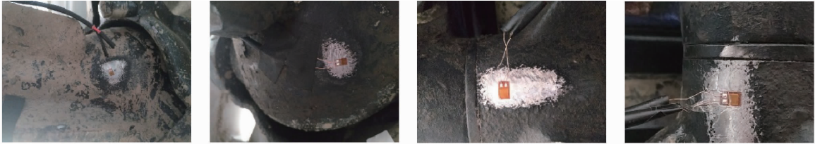
图 7 应变片粘贴效果图
