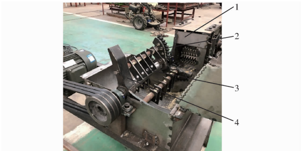
图 5 工作室内部结构图 Fig.5 Internal structure of studio 1. 喂入机构 2. 动刀架 3. 锤片组 4. 抛送板
