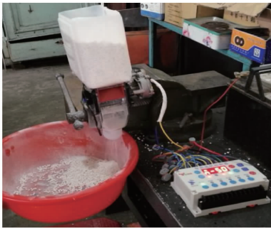
图 6 单一排肥器排肥量监测试验
