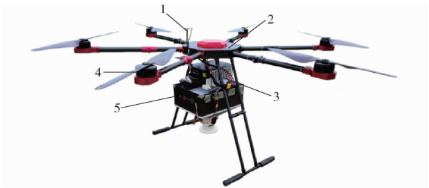
图1 水稻无人机撒肥系统实物图
