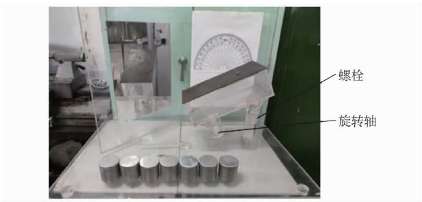
图 3 滑动摩擦试验台
