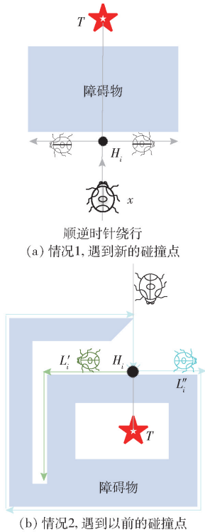
图 7 基于模式 1 的第 1, 2 种情况 Fig. 7 Case 1 and case 2 based on mode 1
