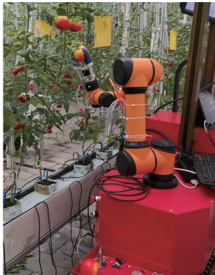
图8 温室环境中机器人采摘试验
