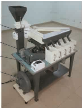
图 8 5TZX-50 型重力分选机实物图
