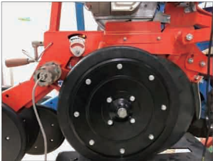
图 3 角度传感器标定 Fig.3 Calibration of angle sensor
