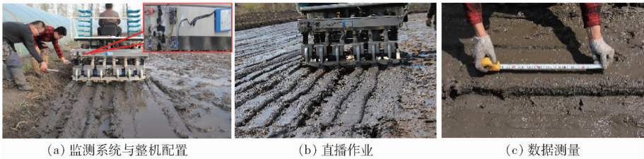
图 20 整机配置与田间试验
