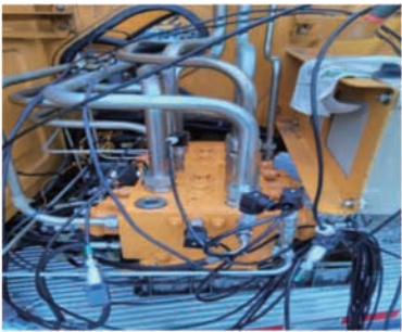
图9 电-液联控合流阀性能测试
