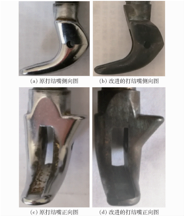
图 17 改进前、后的打结嘴实物图
