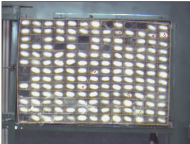
图 9 黄斑茧整体检测结果(正面)
