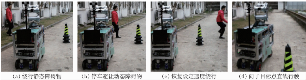
图 17 AGV 绕行 1 个静态障碍物并躲避 1 个动态障碍物的避障试验过程
