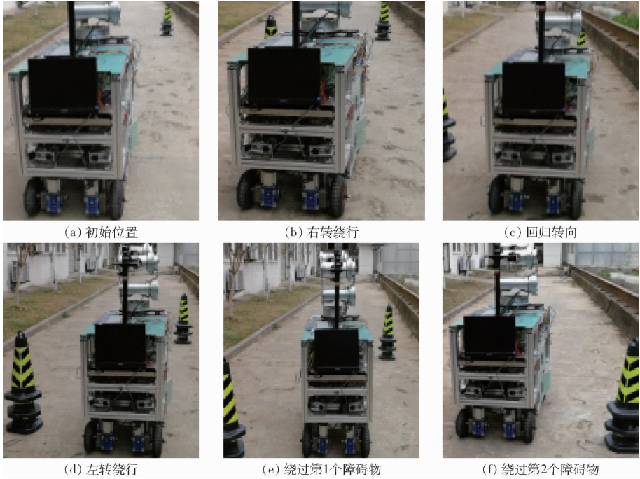
图 15 AGV 依次绕行 2 个大间距静态障碍物的避障试验过程
