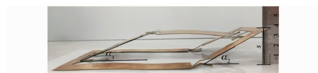
图 12 平面折展四杆机构运动状态实物图
