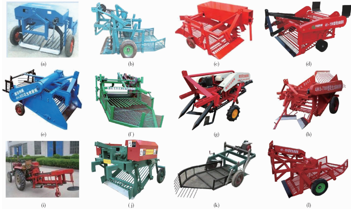
图 10 中国典型花生起收机 Fig. 10 Typical peanut diggers in China
