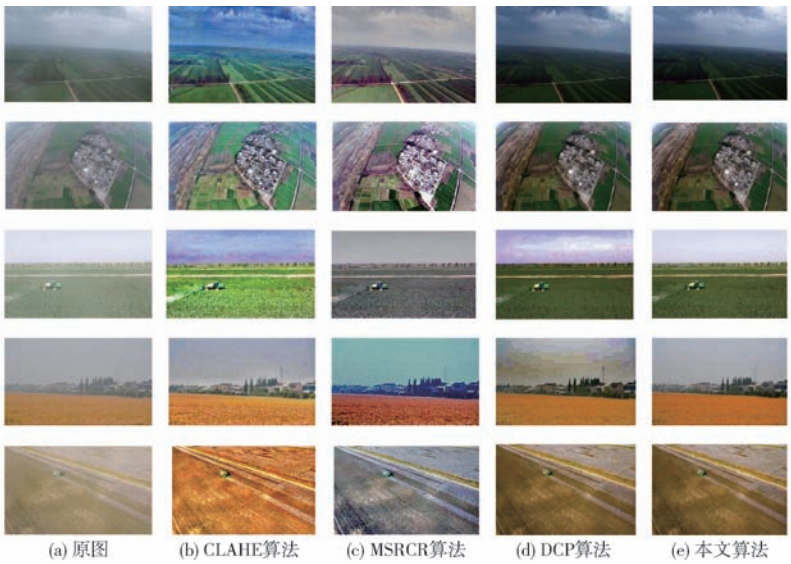
图 7 不同方法去雾效果 Fig. 7 Defogging results of different methods
