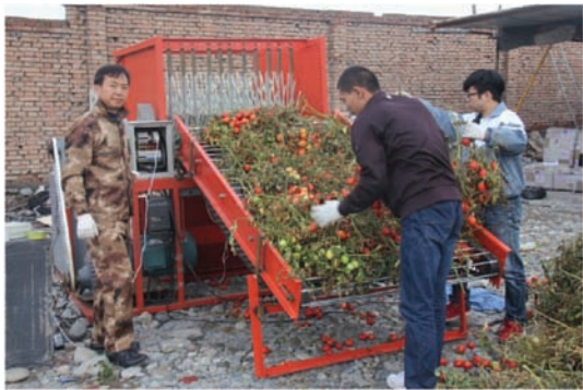
图 3 加工番茄果秧分离试验
