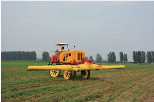
图2 轻便型高地隙喷杆喷雾机
